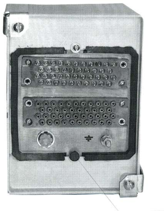
Рисунок 2 – Схема пломбировки от несанкционированного доступа
