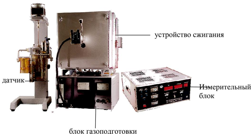
Рисунок 1 – Общий вид экспресс - анализатора на серу АС-7932М
