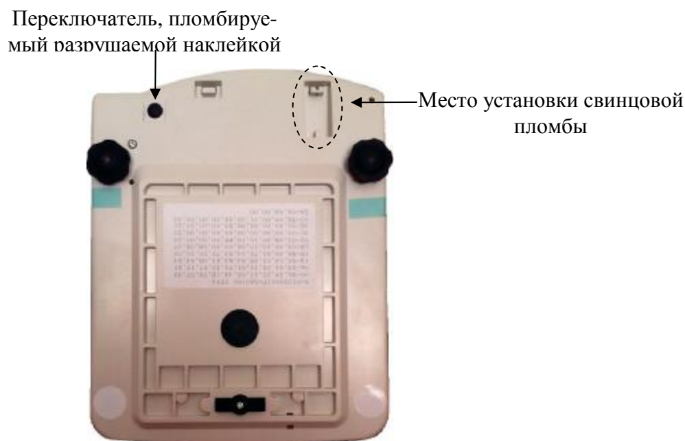
Рисунок 2 - Схема пломбировки весов от несанкционированного доступа.
