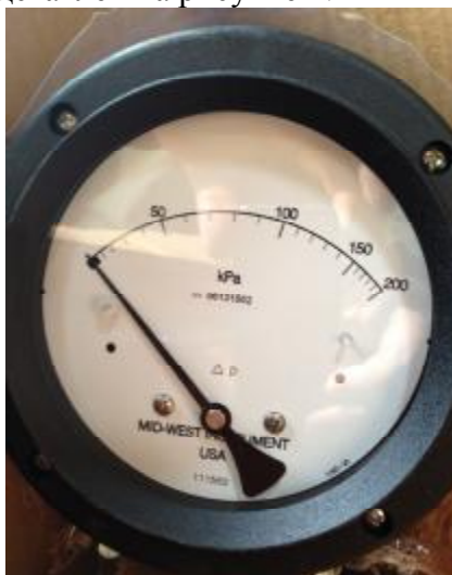
Рисунок 1. Фотография манометра дифференциального модель 140SC-10-(FU)O.
