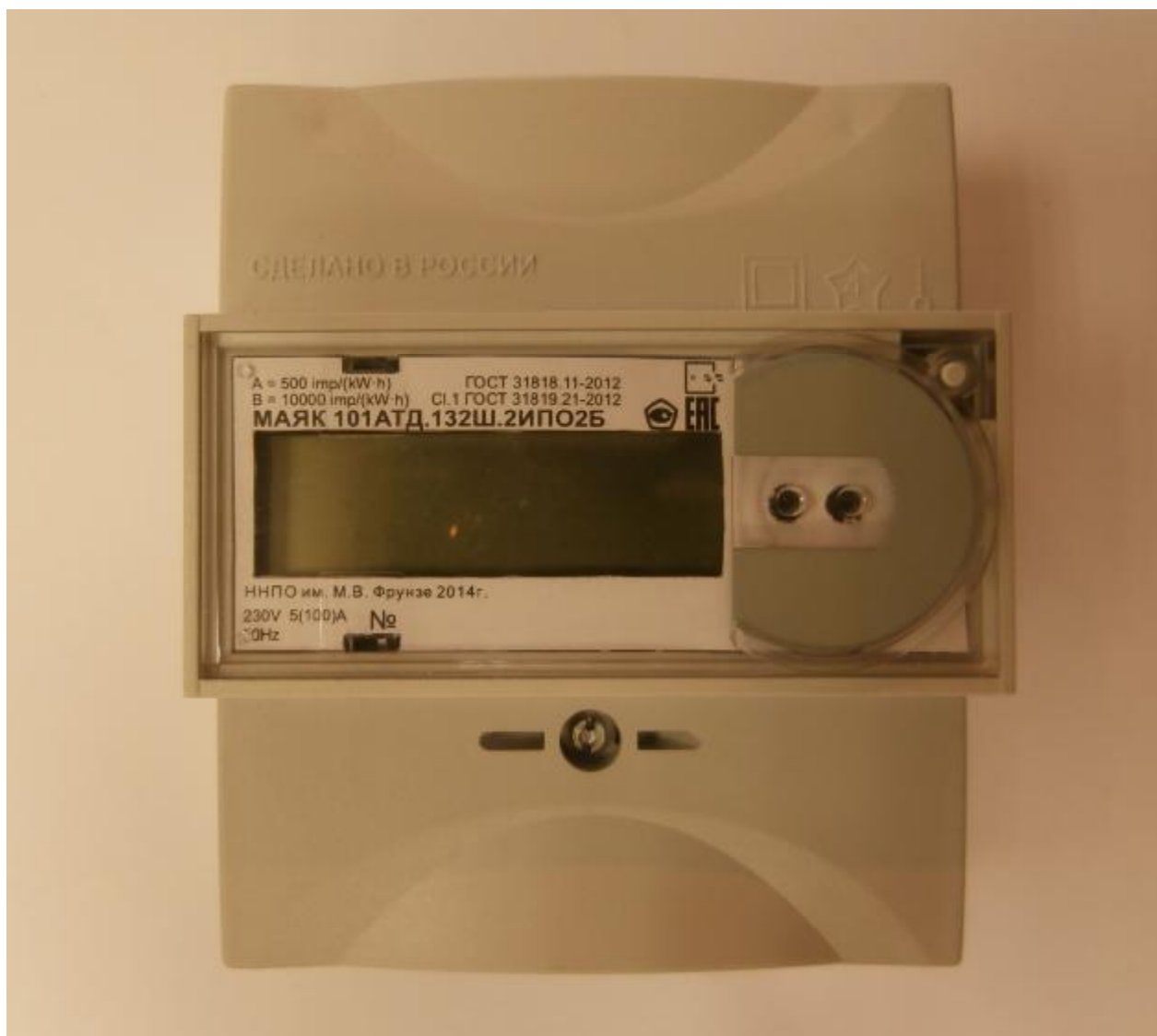
Рисунок 1 – Внешний вид счетчика с закрытой клеммной крышкой
