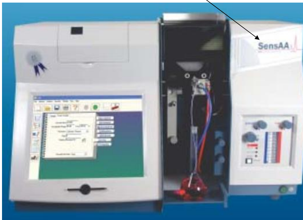
Рисунок 2 – Внешний вид Спектрометров атомно-абсорбционных моделей SensAA, SensAA Dual, SensAA Dual G с указанием места нанесения маркировки
