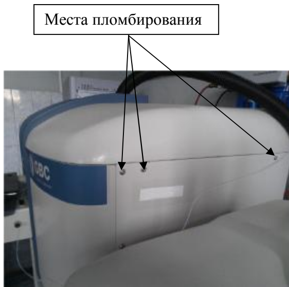
Рисунок 4 – Места пломбирования Спектрометров атомно-абсорбционных моделей SavantAA, SavantAA \Sigma , SavantAA Zeeman, SensAA, SensAA Dual, SensAA Dual G, XplorAA, XplorAA G (вид сбоку)
