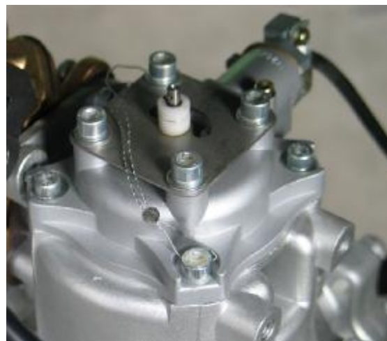
Рисунок 5 - Пломбировка датчика импульсов PS100
