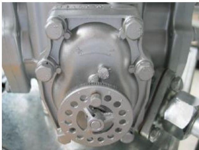
Рисунок 4 - Пломбировка регулировочного винта измерителя объема поршневого типа MJ85
