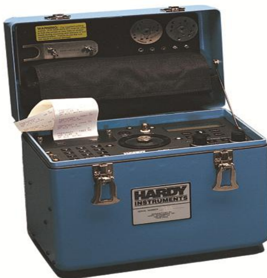
Рисунок 1 - Вибростенд калибровочный переносной модели НН-803
