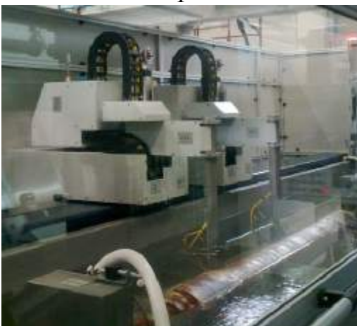
Рисунок 1 – Общий вид установок. На рисунке 1 цифрами обозначены: 1 – электрический шкаф; 2 – операторский пульт; 3 - водный контейнер и ультразвуковые сканирующие головки; 4 - водный контур
