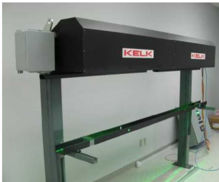
Рис. 2. Внешний вид измерителей ширины полосы проката Accuband модификации C765-F
