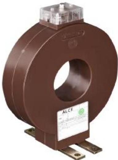
четыре вторичных обмоток, намотанных на тороидальные сердечники. Выводы вторичных обмоток подключаются к клеммным колодкам в коробке вторичных выводов, которая закрыта пломбируемой крышкой для предотвращения несанкционированного доступа к выводам. Трансформаторы могут выполнять функции защиты и измерения. По требованию заказчика трансформаторы могут выпускаться в двух модификациях КА и КАТ, отличающихся конструктивным исполнением.
