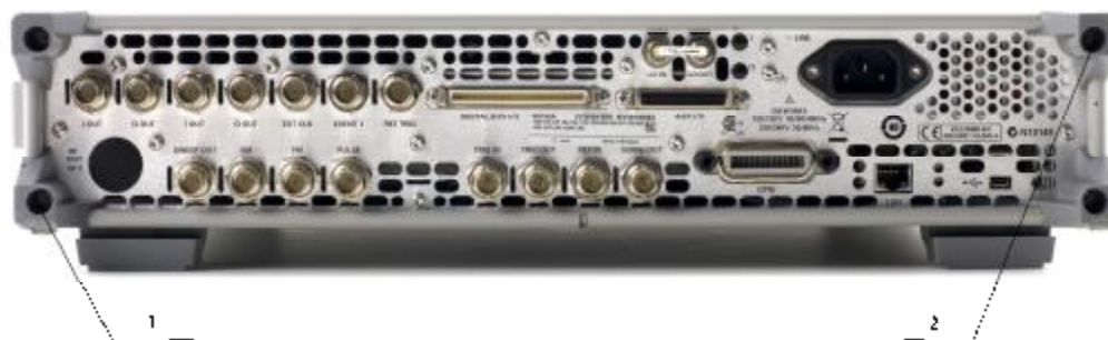
Рисунок 2 – Схема пломбировки генераторов от несанкционированного доступа, где 1; 2 – места для нанесения оттисков клейм.
