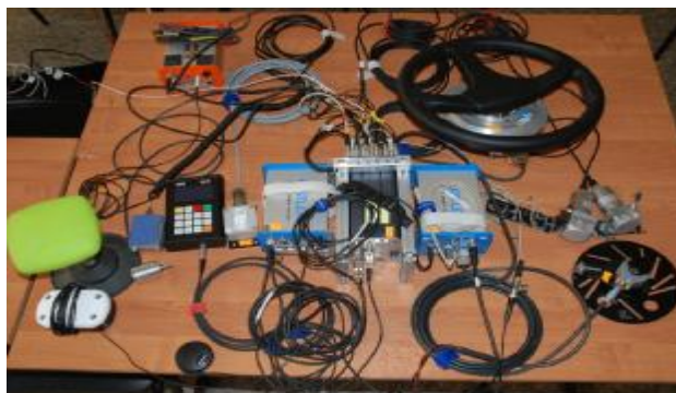
Фотография общего вида системы информационно-измерительной для определения параметров устойчивости, управляемости, тягово-скоростных и тормозных свойств автотранспортных средств imc CS-1016
