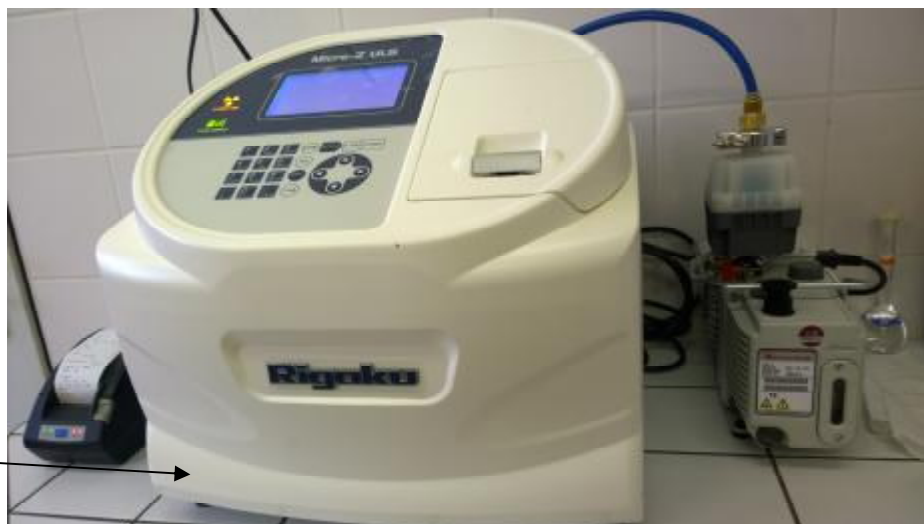
Рисунок 1 – Фото общего вида анализатора серы рентгенофлуоресцентного волно-дисперсионного Rigaku Micro-Z ULS
