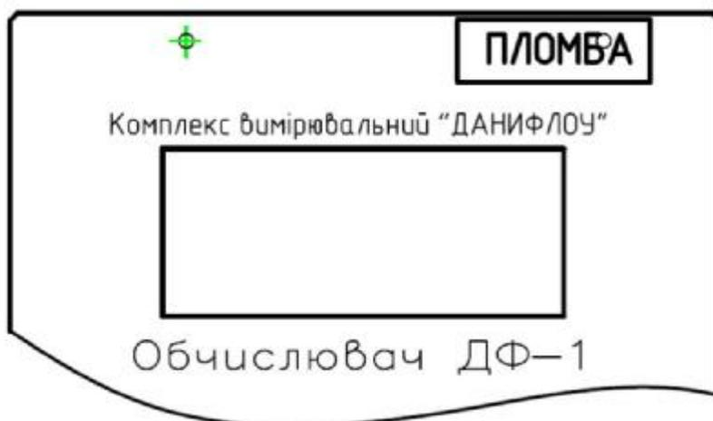
Рисунок 1. Схема установки пломбы.
