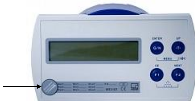
Рис. 2 Схема пломбировки прибора весоизмерительного WE2107.
