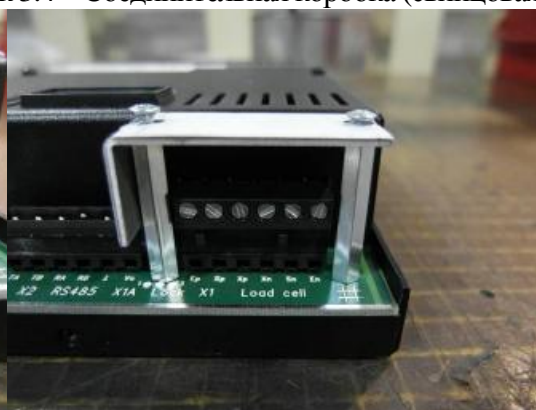
Рисунок 3.4 – Соединительная коробка (свинцовая пломба)
