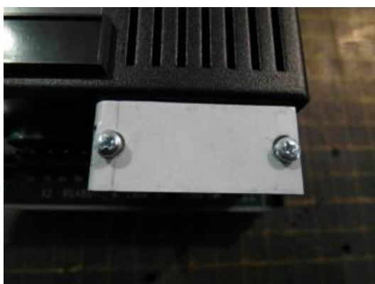
Рисунок 3.5 – Последовательность монтажа калибровочной перемычки на весоизмерительном приборе в месте подключения весоизмерительных датчиков Рисунок 3 –Пломбировка от несанкционированного доступа
