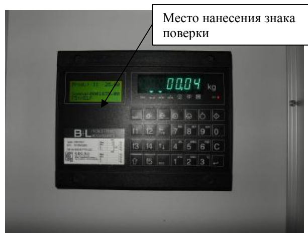
Рисунок 3.1- лицевая панель прибора SWA 2000 С весовое устройство
