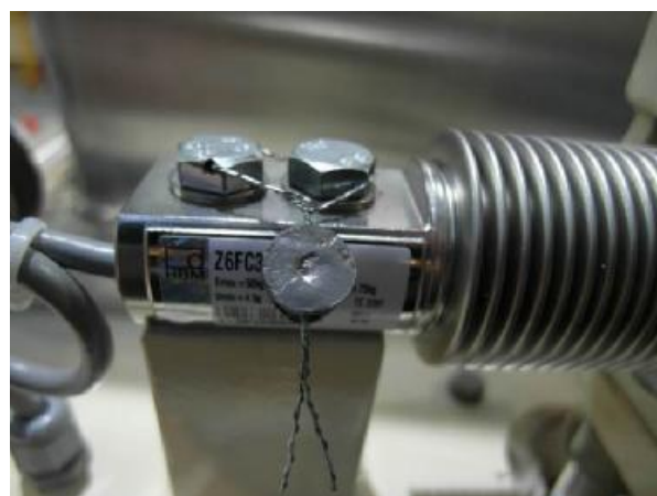
Рисунок 3.2 – Весоизмерительный датчик (свинцовая пломба)
