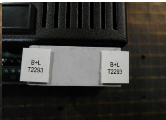
Рисунок 3.5 – Последовательность монтажа калибровочной перемычки на весоизмерительном приборе в месте подключения весоизмерительных датчиков Рисунок 3 –Пломбировка от несанкционированного доступа
