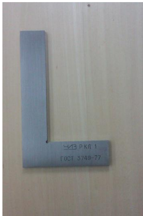
Рисунок 1 – Угольник поверочный 90° слесарный плоский типа УП.
