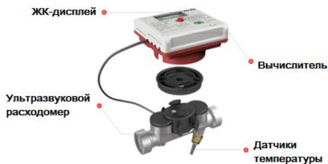
Рис. 1 – Основные части теплосчетчика типа CF (модель CF-UltraMaXX V)
