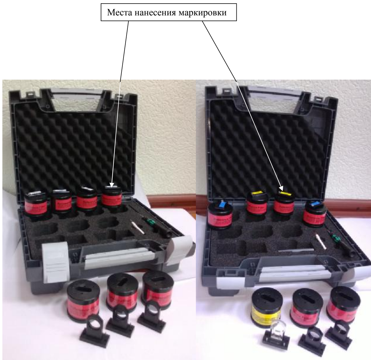
Рисунок 1 – Общий вид комплектов мер оптической плотности UV и VIS-NIR с указанием мест нанесения маркировки
