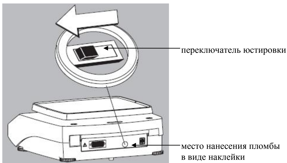
Рисунок 2 - Схема пломбировки от несанкционированного доступа.
