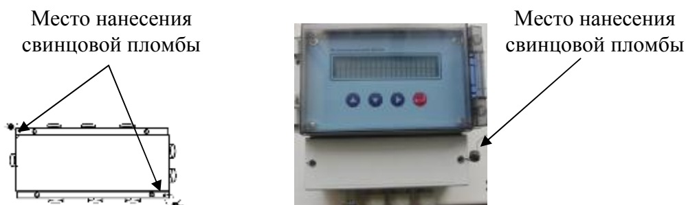
Рисунок 3 – Схема пломбировки корпуса соединительной коробки (слева) и KB-006 (справа)
