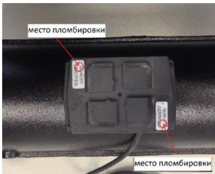
Рис. 5 - Места пломбировки расходомера US BR 473
