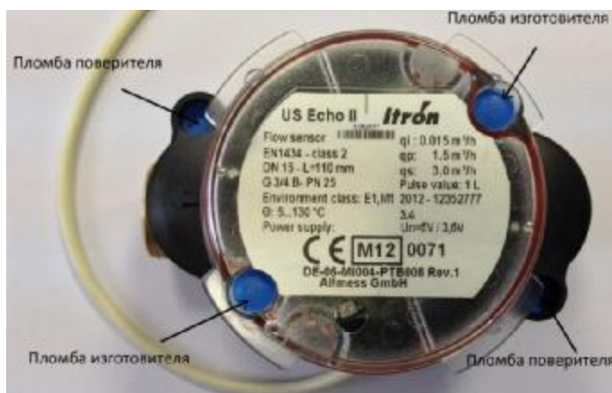
Рис. 3 - Места пломбировки расходомера US Echo II
