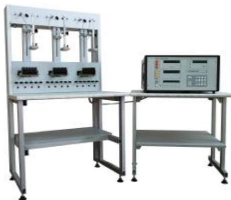
Рисунок 3 - Вид установки со стендом раздельного конструктивного исполнения с контактирующими устройствами на основе горизонтальных контактов.
