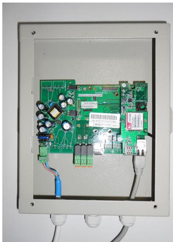
Рисунок 2 Общий вид КМ ЭНТЕК E1R2-G-P-02 без крышки
