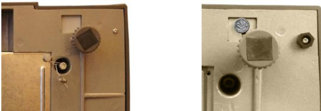
Рисунок 1 - Схемы пломбирования от несанкционированного доступа.
