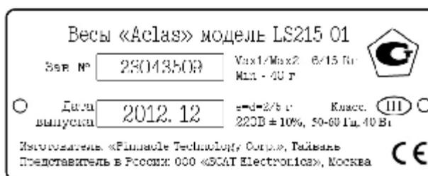
Рисунок 3 –Маркировка весов
