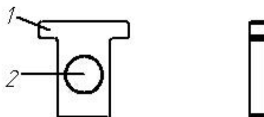
Рисунок 3 – Внешний вид меры оптической, входящей в состав набора мер МО-82-2 (1 – оправка, 2 – светофильтр)
