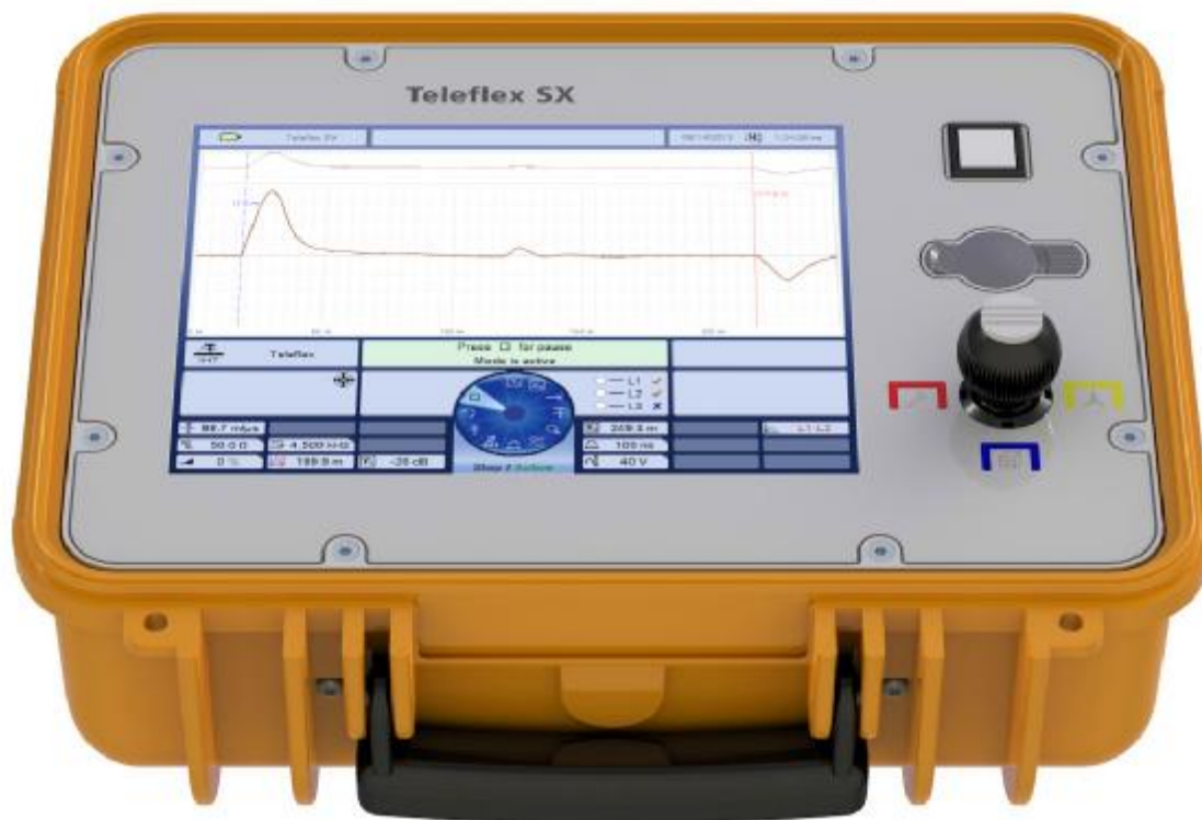
Рис 1 – Внешний вид прибора для обнаружения повреждений кабелей Teleflex SX (откидная крышка снята)
