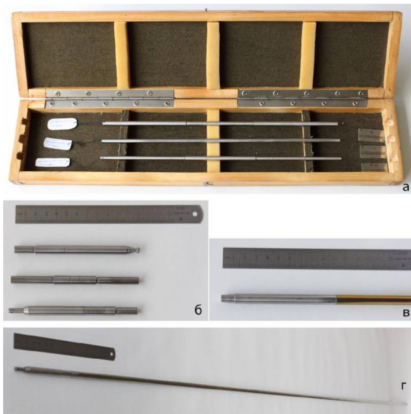
Рисунок 2 - Комплект контрольных образцов: а) КО диаметров и отклонения от прямолинейности; б) элементы КО длины и участков брака по диаметру; в) КО соосности заглушек и оболочки твэл; г) КО длины.
