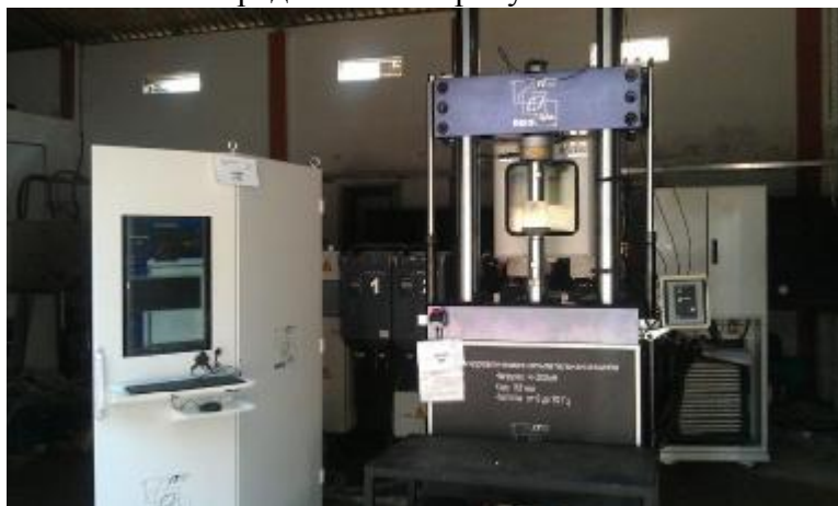
Рисунок 1. Общий вид машины испытательной универсальной испытательной УТ.
