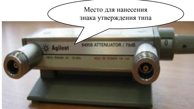
Рисунок 2 – Внешний вид аттенюатора Agilent 8495B
