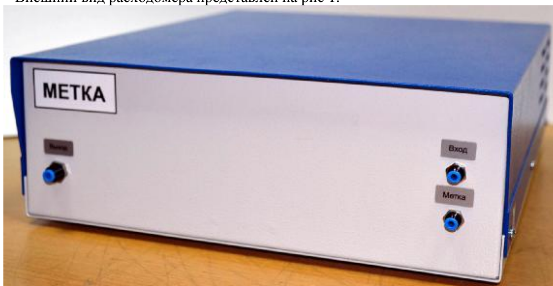
Рис 1. Внешний вид расходомера Метка
