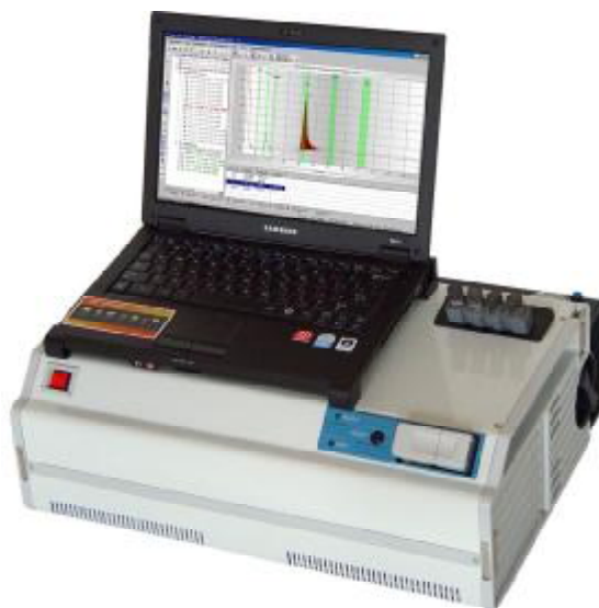
Рис. 1. Внешний вид хроматографов ГХС-02П (GCS-02F)
