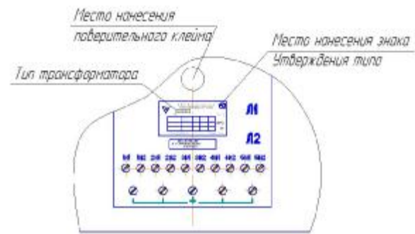
Рисунок 4 - Место нанесения паспортной таблички и поверительного клейма
