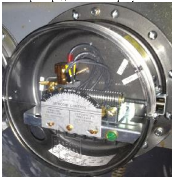
Рис. 1. Внешний вид манометра дифференциального показывающего PG-7200-804-P1.
