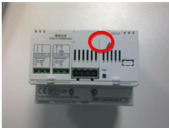
Рис . 1. Фотография счетчика серии iEM3000 (модель iEM3155). Красным кругом выделено место установки клейма поверителя в виде наклейки.
