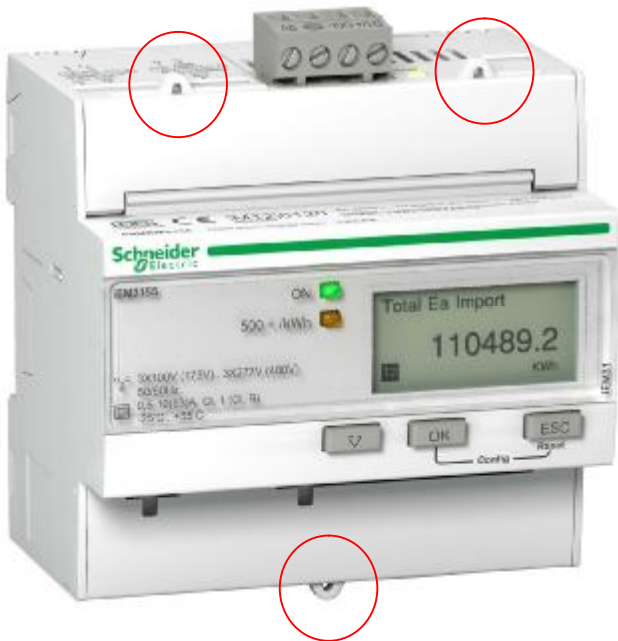
Рис. 2. Фотография счетчика серии iEM3000 (модель iEM3155). Красными кругами выделены проушины для установки пломб энергоснабжающей организации.
