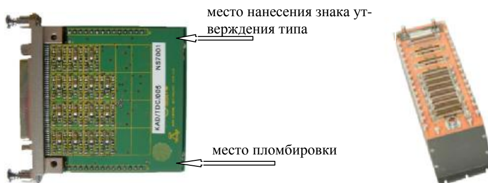
Рисунок 1 - Внешний вид модуля KAD/TDC/005 и модуля KAD/TDC/005 установленного в блок базовый КАМ/СНС/13U
