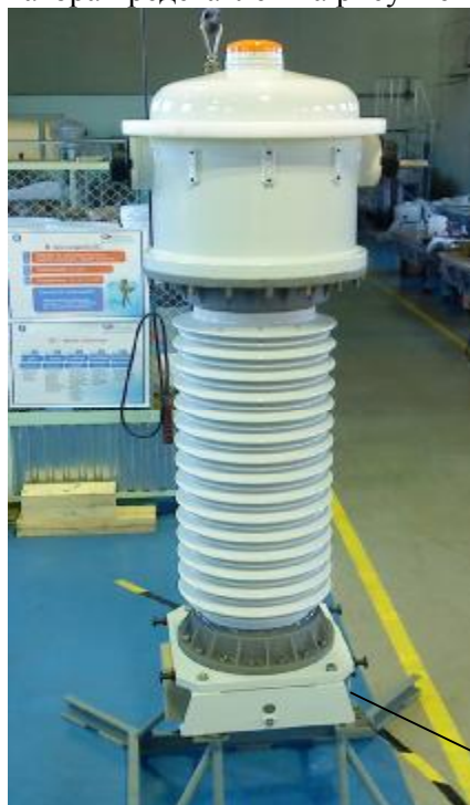
Рисунок 1 – Общий вид трансформатора тока ТОГМ – 110
