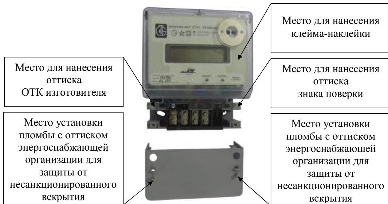
Рисунок 3 – Место нанесения отиска знака поверки и общий вид счетчика исполнения СТК1
