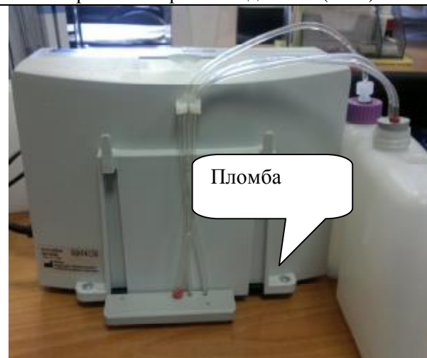
Рисунок 2 – Экспресс-анализатор биохимический автоматический Innovastar. Расположение пломбы.
