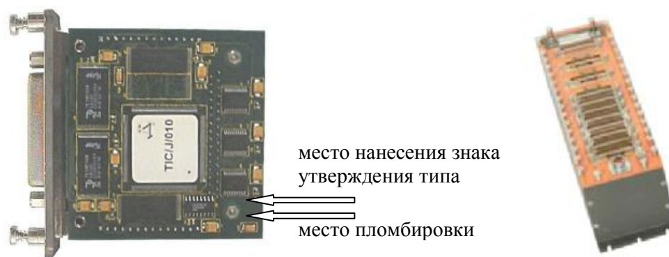
Рисунок 1 - Внешний вид модуля KAD/DSI/003/B установленного в блоке базовом КАМ/CHS/13U
