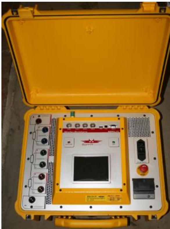
Конструктивно измеритель выполнен в пластиковом противоударном, виброзащищенном, водонепроницаемом корпусе, снабженном крышкой с автоматическим клапаном для уравнивания давления внутри и снаружи прибора. Фронтальная панель прибора выполнена из анодированного металла.
