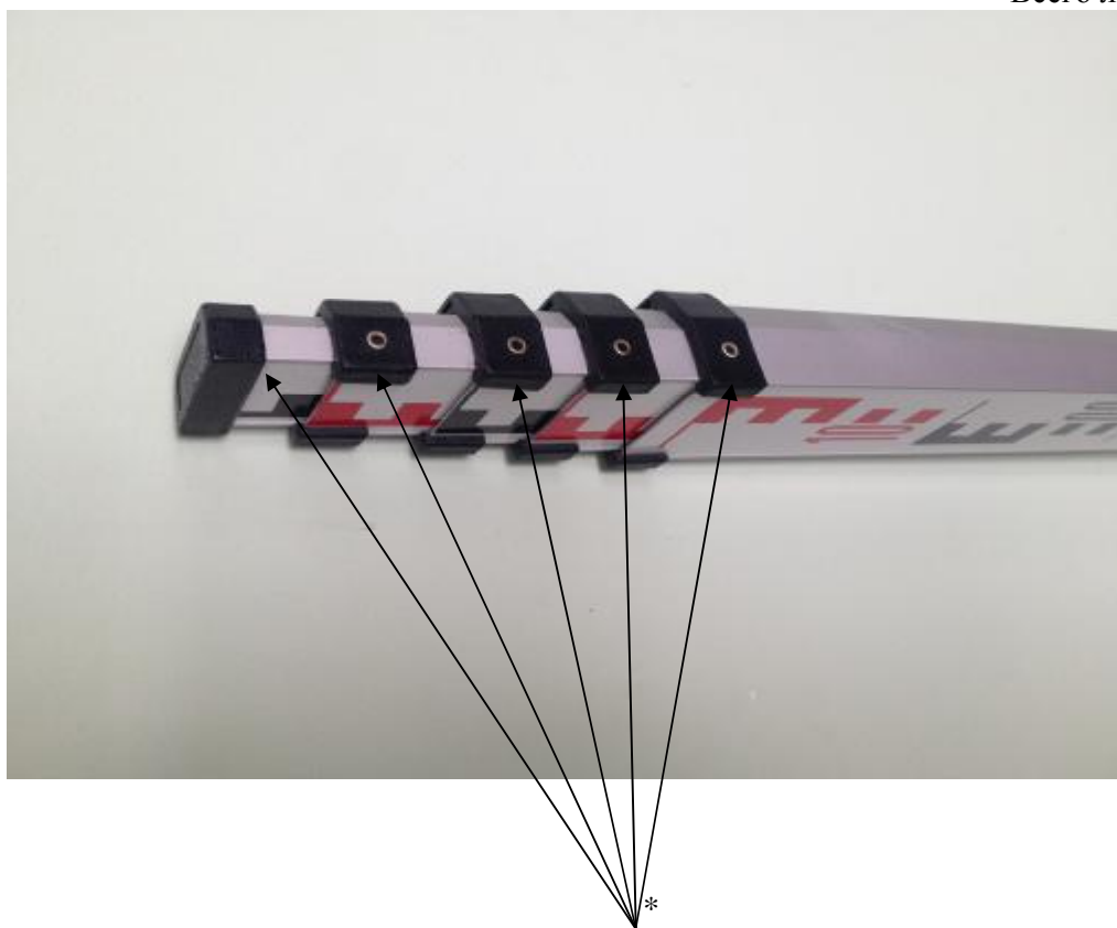
Рисунок 4 - Схема пломбировки от несанкционированного доступа
