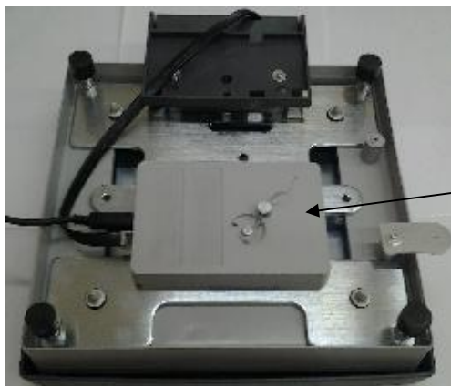
Рисунок 1 - Схема пломбирования от несанкционированного доступа.
