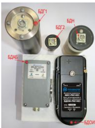
Рисунок 2 – Места пломбирования БДОИ и внешних блоков детектирования
