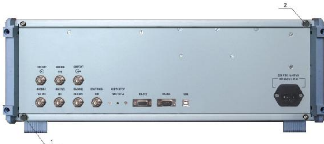
Рис. 2 Схема пломбировки установки.
