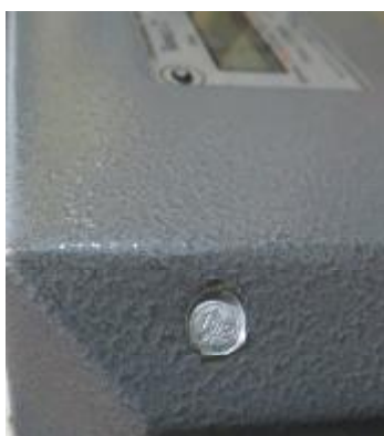
Рисунок 2. Место пломбирования счётчика при выпуске
