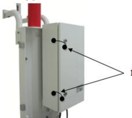
Рисунок 2. Схема пломбирования нефелометров FS11P. 1 – пломбы на интерфейсном блоке.
