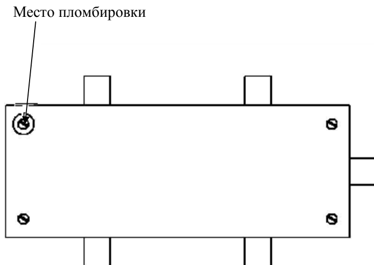
Рисунок 4 – Схема пломбировки соединительной коробки.
