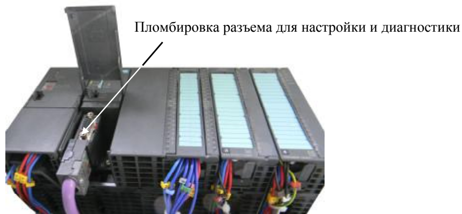
Рисунок 2 — Схема пломбировки от несанкционированного доступа
